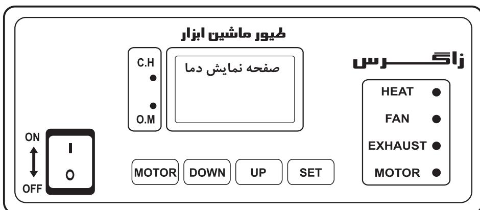
۱) کلید POWER جهت روشن و خاموش کردن دستگاه.
